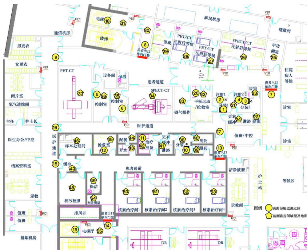
图 3-4 核医学科表面污染监测点位示意图
